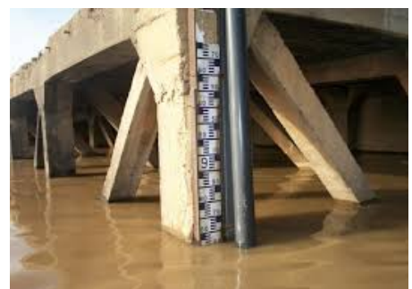
Escala limnimétrica en el río Senegal © OMVS
