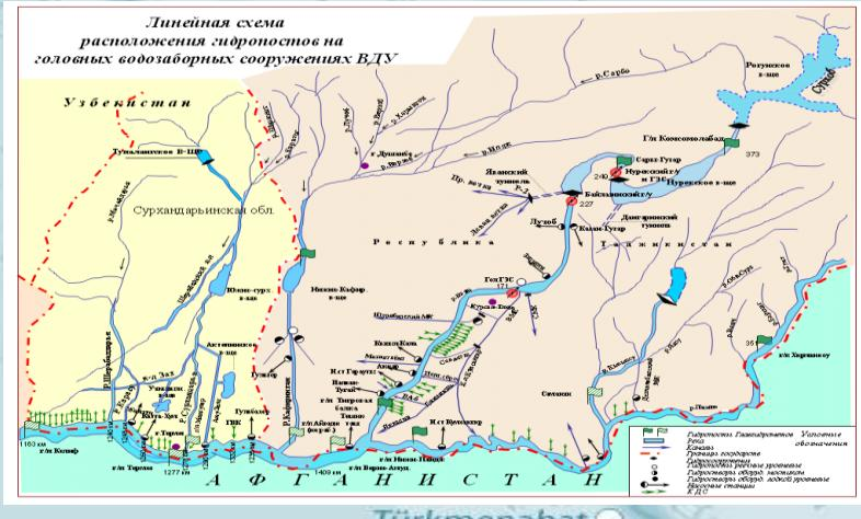
III УПРАДИК - Осуществляет эксплуатацию 11 речных водозаборов, 52 гидротехнических сооружений на магистральных каналах, содержит и эксплуатирует 341 км магистральных каналов, контролирует водозаборы на участки реки длиной 167 км от Туймуюнского гидроузла до гидропоста Кипчак
